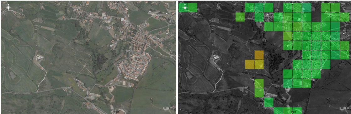
Figura 28. Zona de Cotovios (izquierda). Se observan velocidades de movimiento del terreno en dirección LOS de más de 2 cm/año posiblemente ligados a un movimiento de ladera (derecha).
