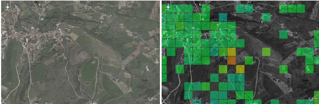
Figura 25. Zona del Monte Mourão (358 m) (derecha). Se observan velocidades de movimiento del terreno en dirección LOS de más de 1,5-2 cm/año ligados a deslizamientos conocidos en esa zona (izquierda).
