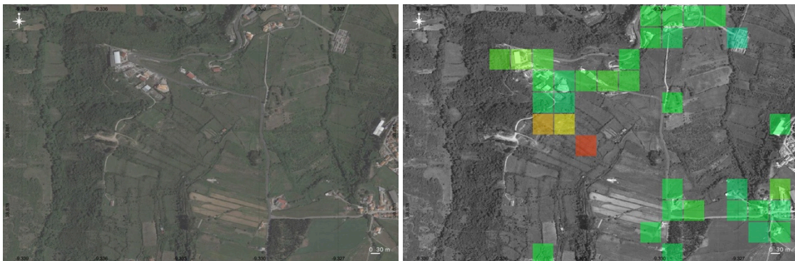
Figura 29. Zona de Cheleiros (izquierda). Se observan velocidades de movimiento del terreno en dirección LOS de más de 2 cm/año posiblemente ligados a un movimiento de ladera (derecha).
